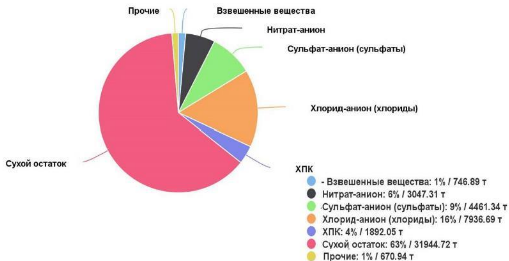
Рис. 1. – Структура сброса загрязняющих веществ в сточных водах на ВХУ 10.01.01.012 за 2021 год
