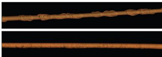
Рис. 1. Сравнение качества ствола скважины, построенного по данным квернмера: сверху – ВЗД с кривым переводником, снизу – РУС
