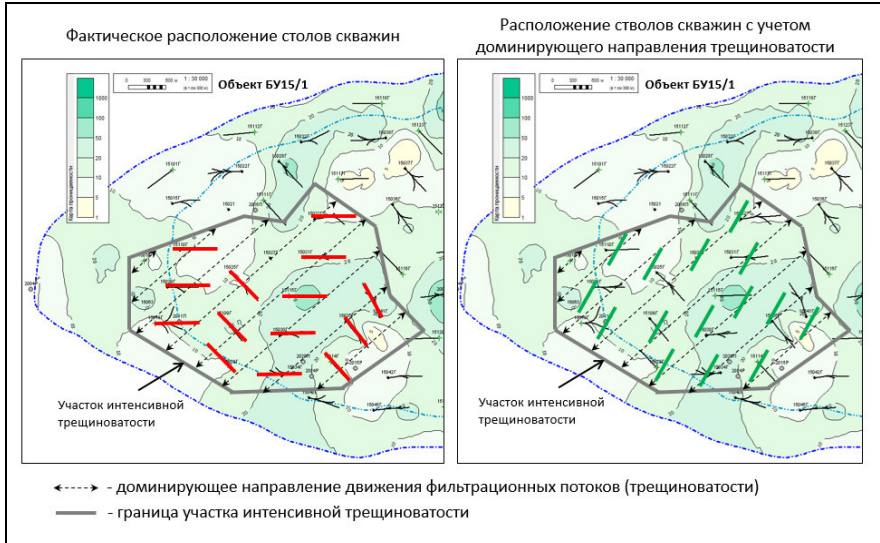
Рис. 3. Фрагмент карты изучаемого участка с фактическим и альтернативным (с учетом доминирующего направления фильтрации) расположением стволов скважин
