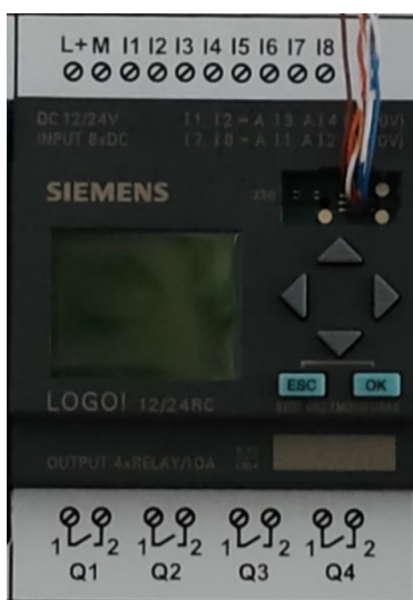
Рис. 1.1.3. Внешний вид программируемого реле Siemens LOGO!
