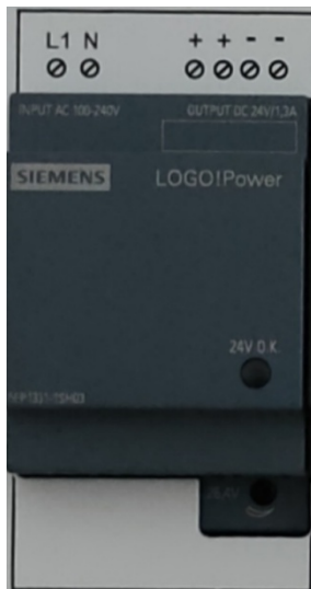
Рис. 1.1.5. Внешний вид блока питания LOGO!Power
