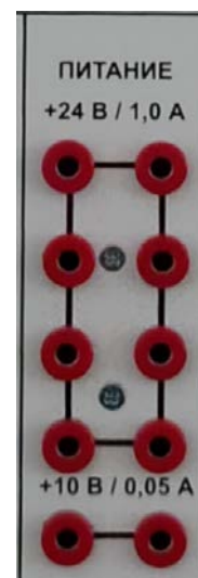
Рис. 1.1.8. Внешний вид блока разъемов выходов источников питания
