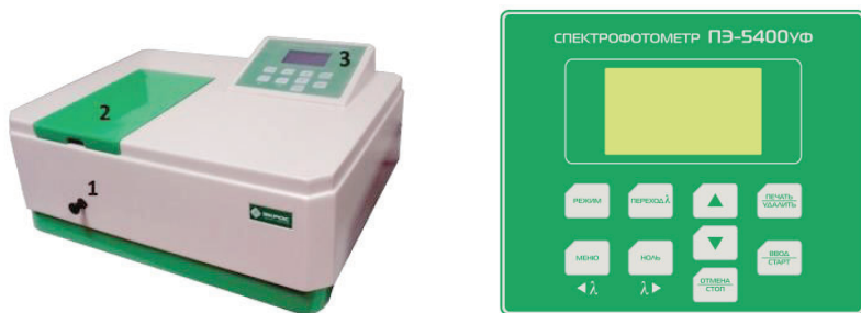
Рис. 5. Внешний вид спектрофотометра ПЭ-5400 УФ: 1 – ручка перемещения кювет; 2 – крышка кюветного отделения; 3 – панель управления
