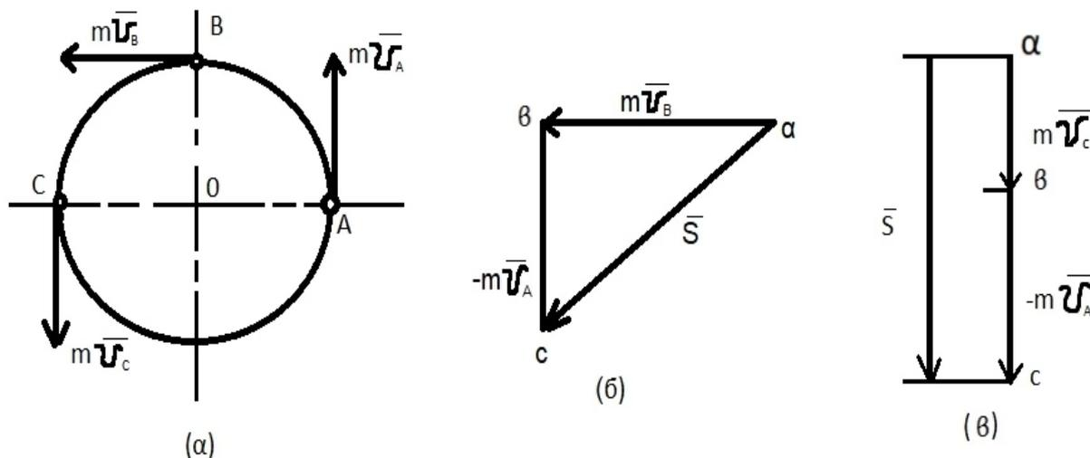
Рис. 15. Схема равномерного движения точки по окружности с примерами решения для двух случаев
