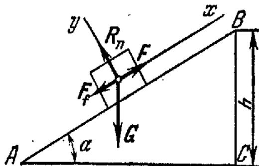
Рис. 26. Схема равномерного движения груза по наклонной плоскости (Интернет-ресурс)
