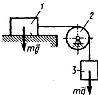
Рис. 7. Схема движения груза по гладкой горизонтальной плоскости
