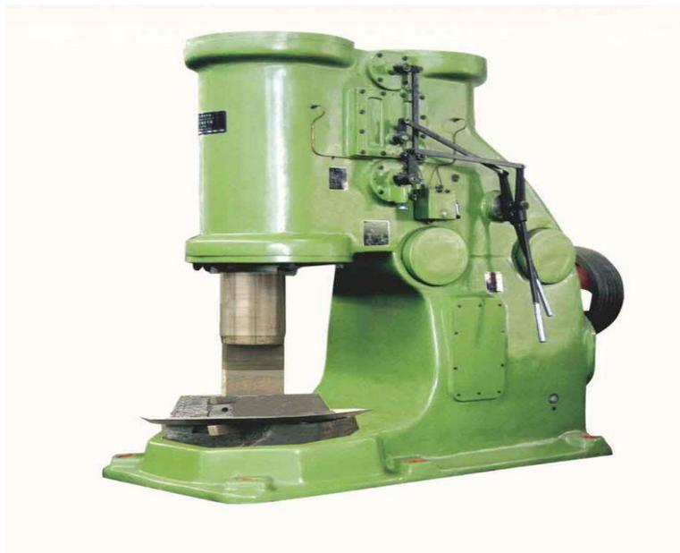
Рис. 16. Пневматический ковочный молот (Интернет-ресурс)
