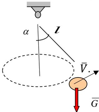
Рис. 4. Схема перемещения груза на нити в горизонтальной плоскости
