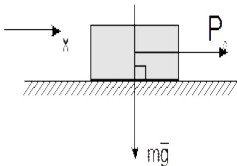
Рис. 11. Схема движения груза массой  $m$  под действием силы  $\bar{P}$  по горизонтальной плоскости
