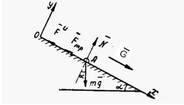
Рис. 39. Схема движения груза по шероховатой наклонной плоскости
