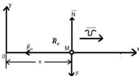
Рис. 10. Схема движения груза  $M$  массой  $m$  по шероховатой горизонтальной плоскости
