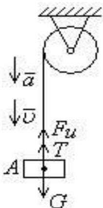
Рис. 47. Распределение сил при равноускоренном движении груза (Интернет-ресурс)
