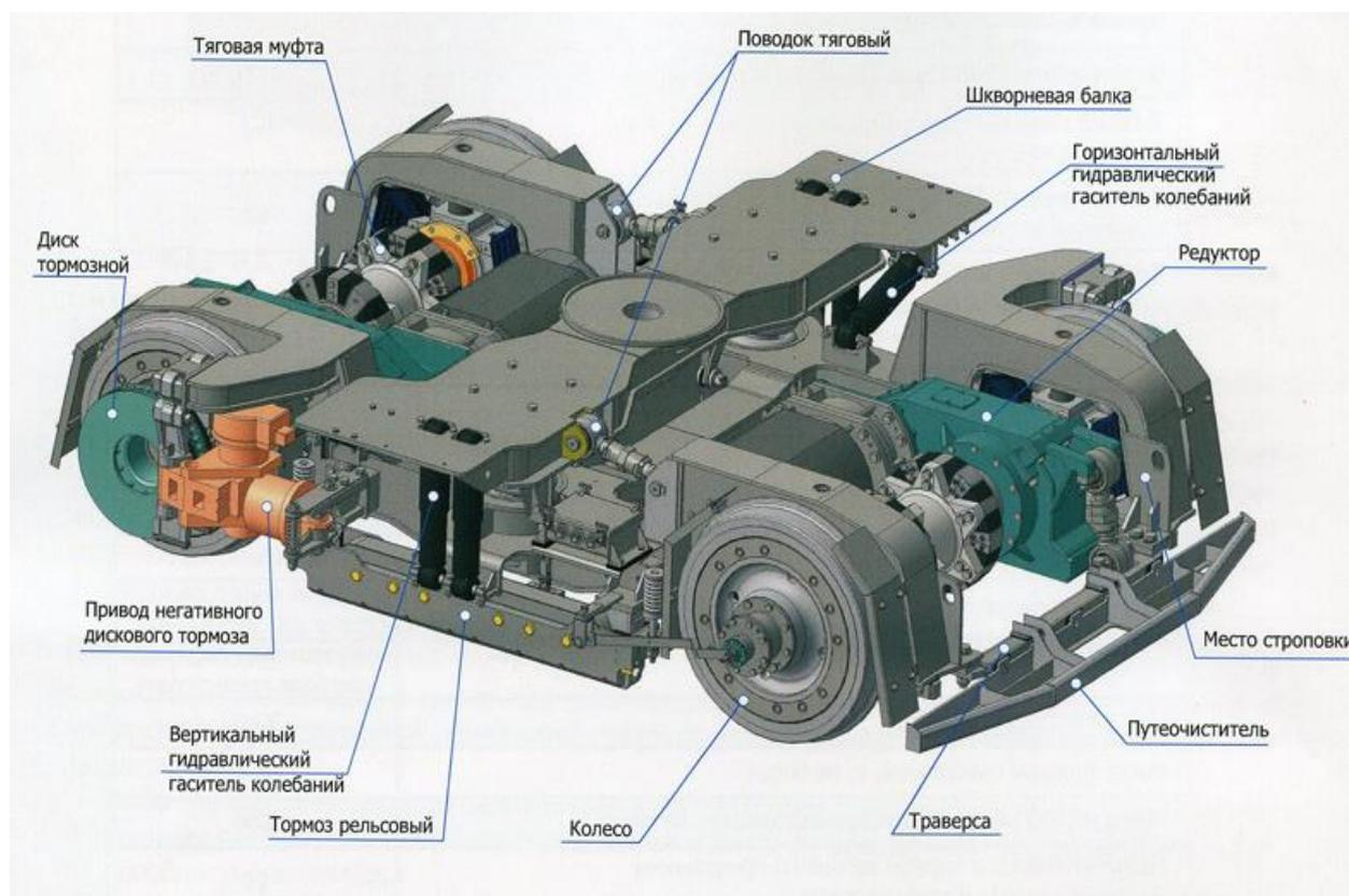
Рис. 43. Ходовая тележка типового трамвайного вагона (Интернет-ресурс)
