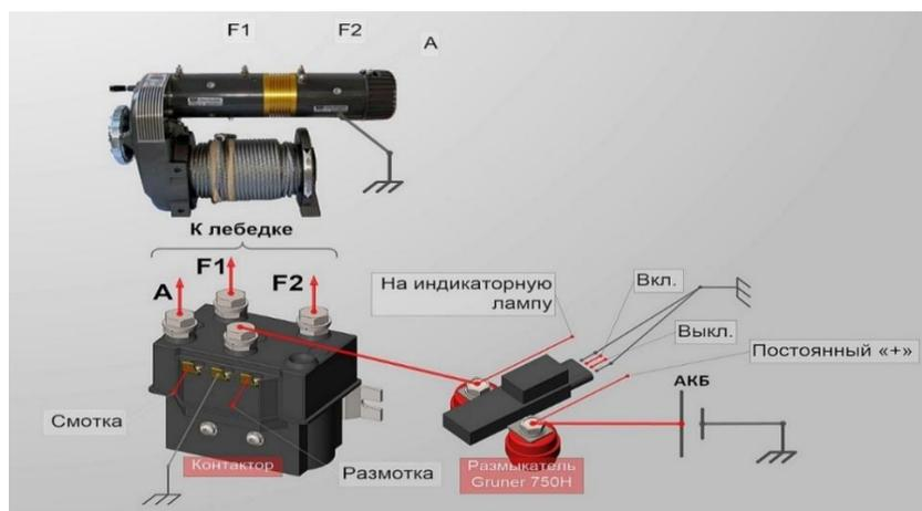
Рис. 34. Типовая схема передачи мощности электродвигателя на лебедку токарного станка (Интернет-ресурс)
