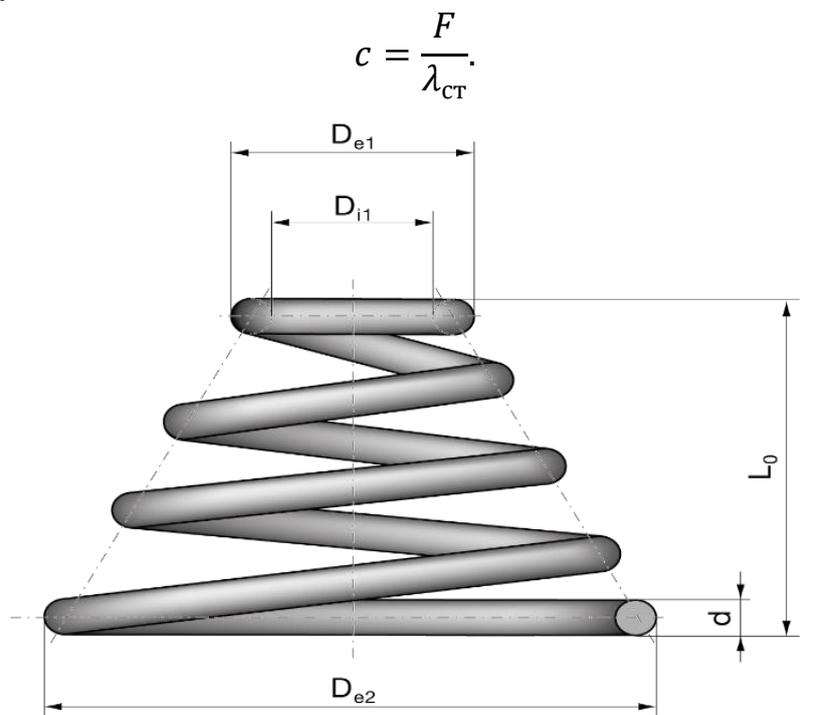
Рис. 24. Винтовая пружина с геометрическими размерами (Интернет-ресурс)
