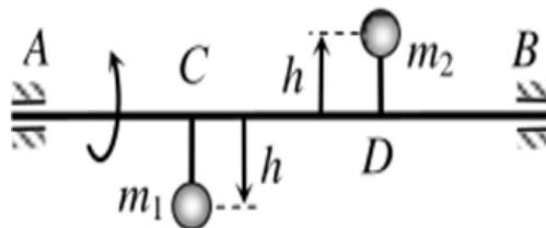
Рис. 45. Схема вращения вала с сосредоточенными массами (Интернет-ресурс)
