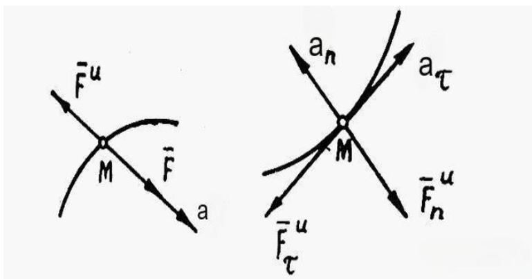
Рис. 37. Принцип Даламбера для материальной точки в координатных и естественных осях
