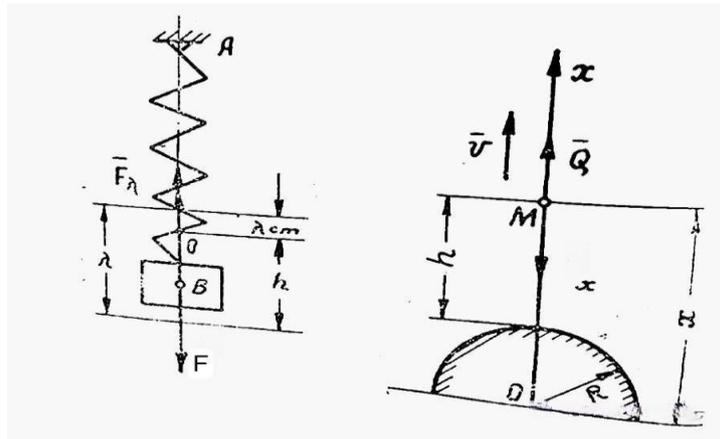
Рис. 25. Работа сил, приложенных к грузу, закрепленному на пружине
