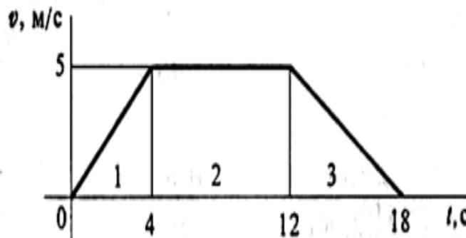
Рис. 46. График изменения скорости лифта при подъеме (Интернет-ресурс)
