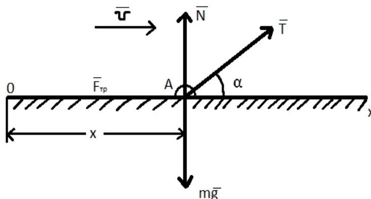
Рис. 14. Схема движения груза  $A$  под действием силы  $\bar{T}$
