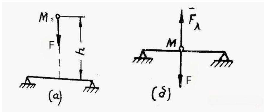
Рис.30. Две схемы падения груза весом  $\bar{F} = \bar{G}$  на середину балки
