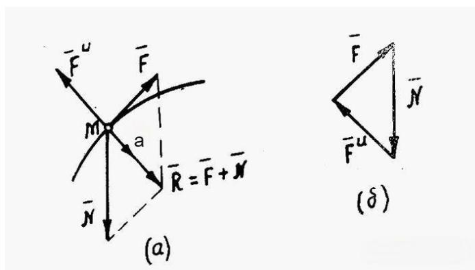
Рис. 38. Уравновешивающая система сил и силовой треугольник
