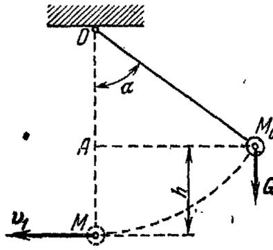
Рис.31. Схема движения материальной точка массы  $m$ , прикрепленной тросом длиной  $l$  к неподвижной точке  $O$
