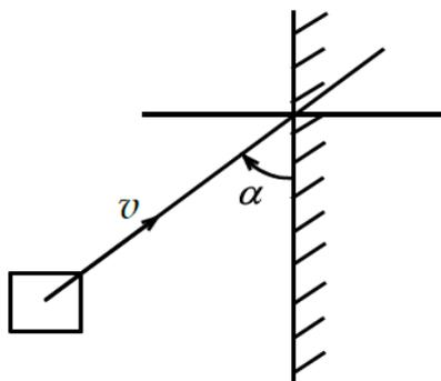
Рис. 21. Движение кубика по гладкой горизонтальной плоскости до момента удара с шероховатой вертикальной стенкой (Интернет-ресурс)
