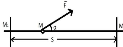
Рис. 22. Работа силы постоянной по модулю
