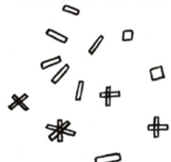
Кристаллы \text{Hg}_2\text{Cl}_2 , полученные восстановлением хлористым оловом (увеличение в 150-200 раз)
