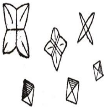
Кристаллы \text{CaC}_2\text{O}_4 , осажденные щавелевокислым аммонием
