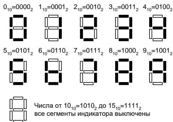
Рисунок 7.3 – Соответствие двоичных кодов и сегментов индикатора
