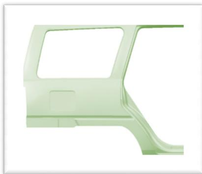
Рис. 2. Виртуальная геометрическая модель заднего крыла автомобиля ИЖ-21261
