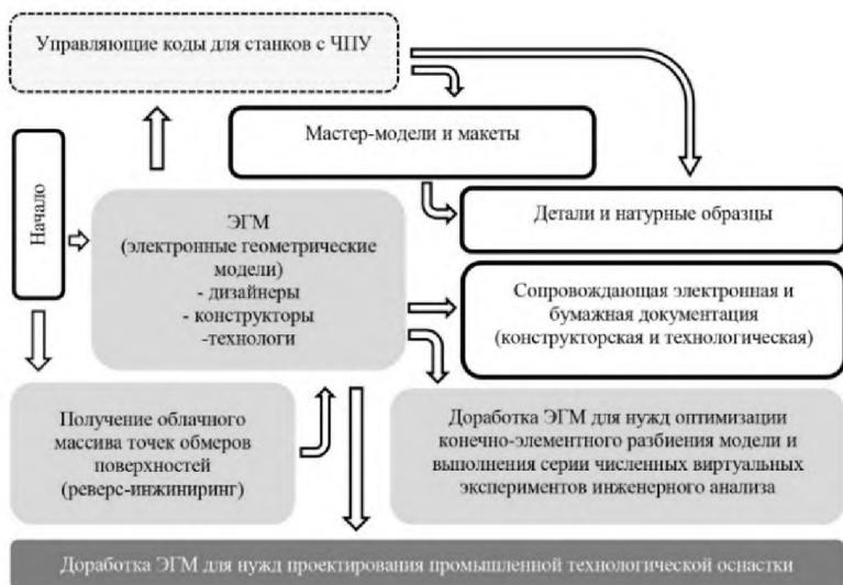
Рис. 1. Схема подготовки и использования трехмерной виртуальной электронной геометрии при проектировании транспортных средств
