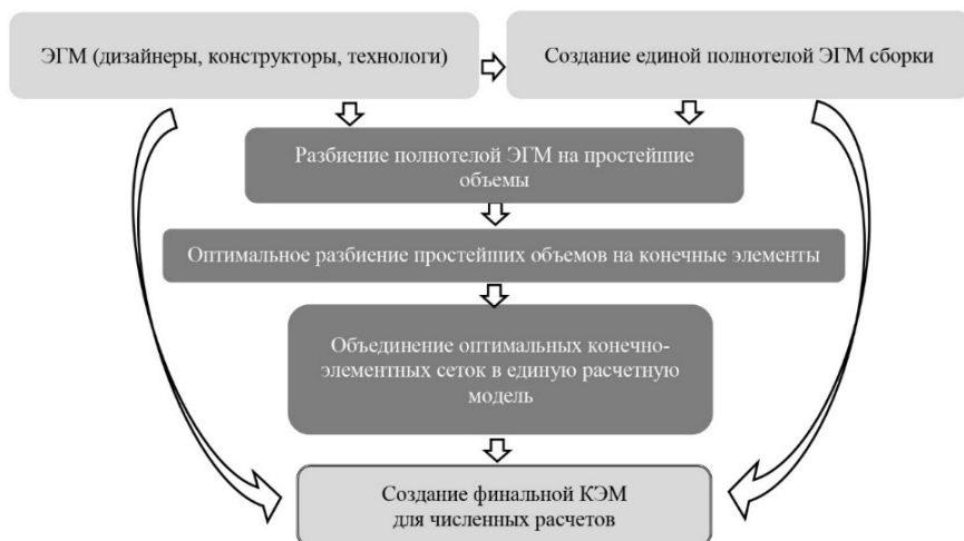
Рис. 1. Схема детальной подготовки ЭГМ для оптимального конечно-элементного разбиения
