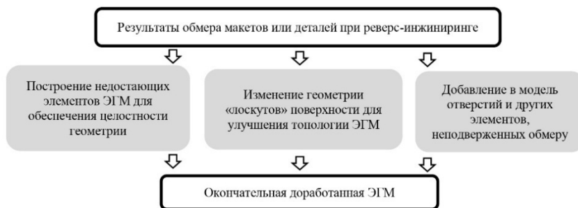
Рис. 3. Примерная схема работ по генерации проектной ЭГМ детали на основании данных поверхностной оцифровки
