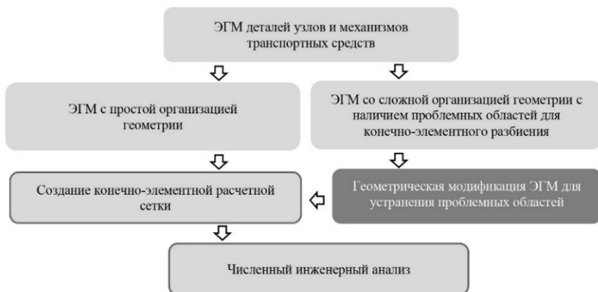
Рис. 3. Схема подготовки конечно-элементной модели на основе проектной ЭГМ
