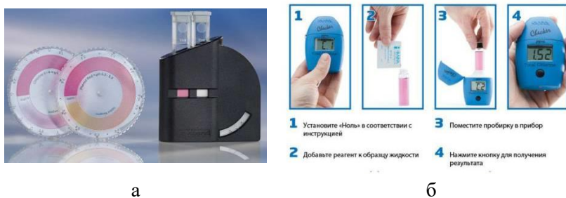
Рис. 12. Компаратор СHECKIT (Lovibond, Германия) (а) и колориметр серии Checker (Hanna instruments, Германия) (б)
