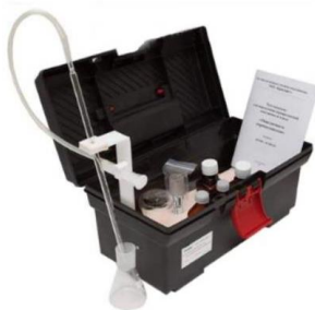
Рис. 11. Наборы для титрования: а – тест-набор VISOCOLOR®HE Хлориды CL 500 (MACHEREY-NAGEL GmbH & Co. KG, Германия), б – тест-комплект «Окисляемость перманганатная» (ЗАО «Крисмас+», г. Санкт-Петербург)
