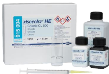
Рис. 11. Наборы для титрования: а – тест-набор VISOCOLOR®HE Хлориды CL 500 (MACHEREY-NAGEL GmbH & Co. KG, Германия), б – тест-комплект «Окисляемость перманганатная» (ЗАО «Крисмас+», г. Санкт-Петербург)
