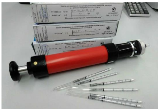
Рис. 9. Набор индикаторных трубок с насосом-пробоотборником ООО «ИМПУЛЬС» (г. Санкт-Петербург)
