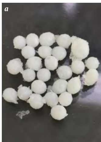
Гидрогели ПВС/АН: a — после шивания в течение первого дня в \text{CaCl}_2 + \text{H}_3\text{BO}_3 ; б — срез гидрогеля, полученный стандартным методом, окрашивание крезильным фиолетовым. Увеличение объектива \times 40
