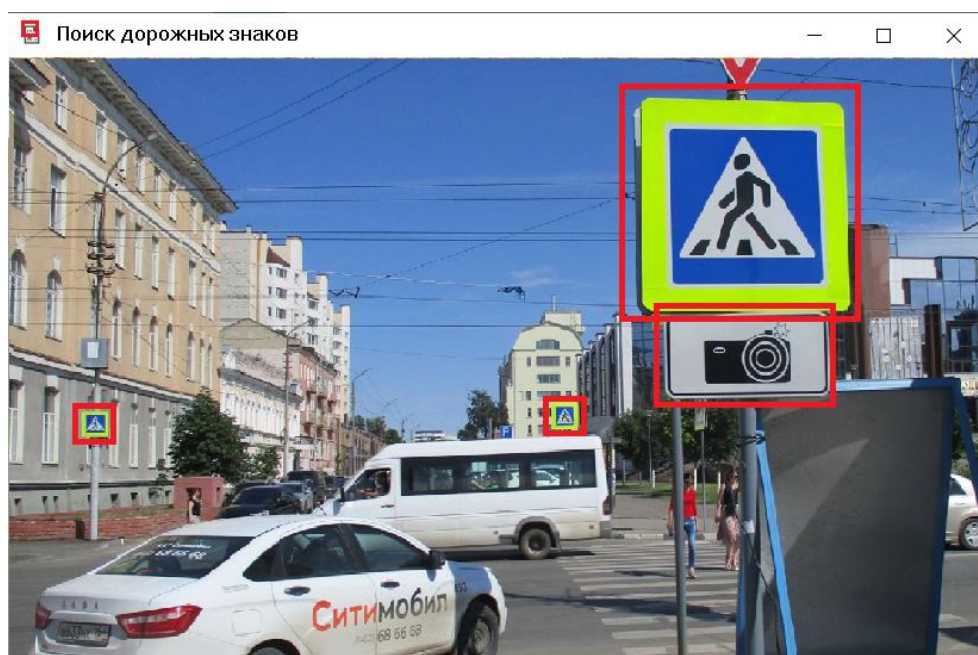
Рис. 3. Пример работы программы по поиску дорожных знаков
