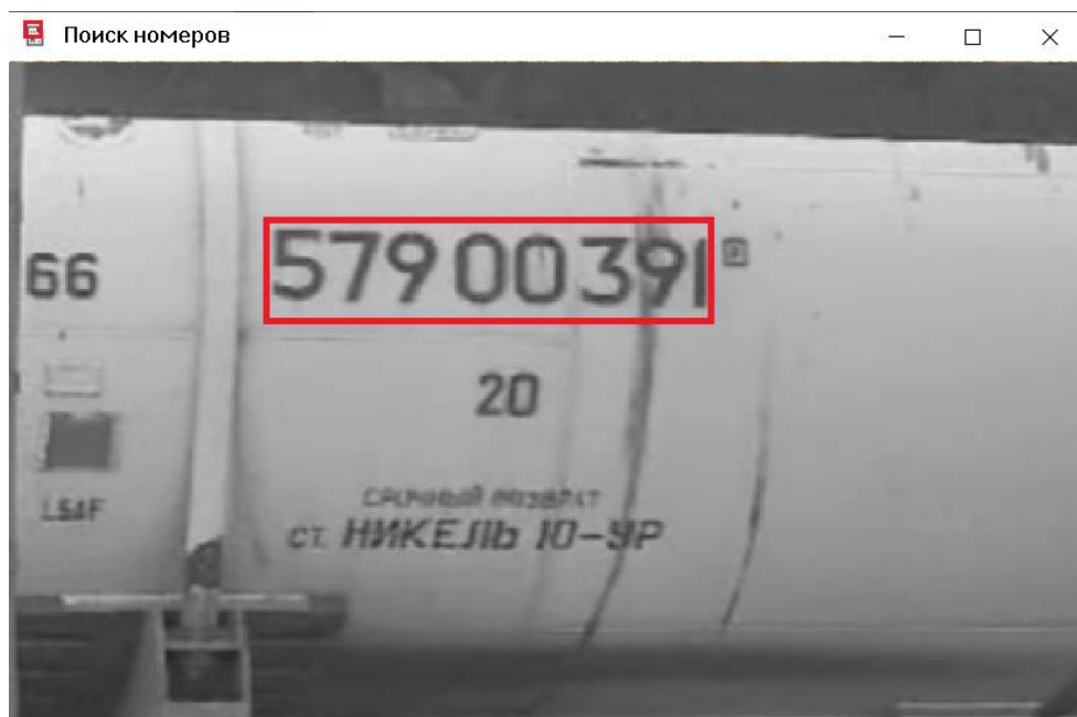
Рис. 4. Пример работы программы по поиску номеров железнодорожных вагонов
