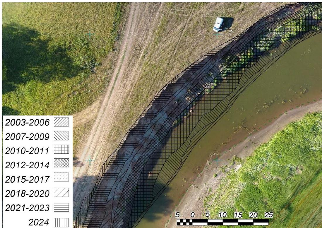
Рис. 3. Совмещение наземной съемки размываемого берегового уступа р. Кырыкмас за период 2003–2024 гг. с ортофотопланом (залет 2021 г.)
