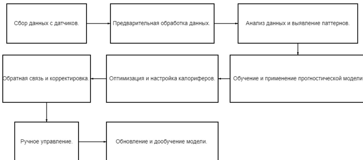
Рис. 1. Блок-схема интеллектуальной настройки микроклимата для калориферной системы отопления.
