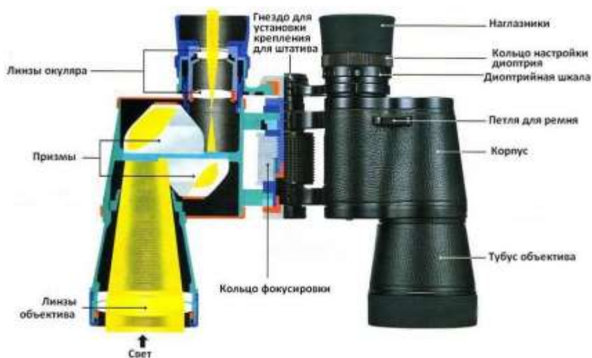
Рис. 13. Схема устройства бинокля. Изображение из открытых источников
