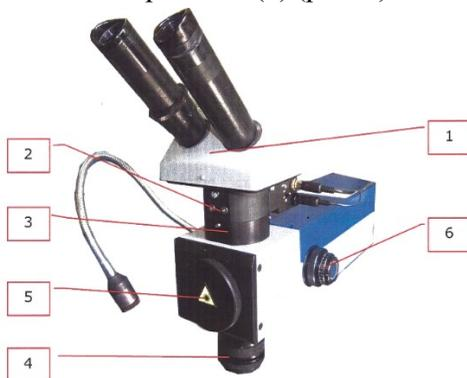
Рис. 4. Оптическая система наблюдения и фокусирующая система
