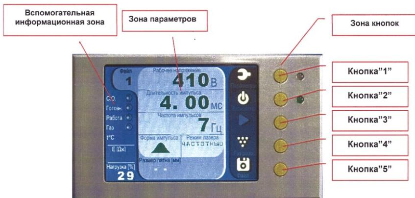
Рис. 7. Расположение информационных зон на панели управления
