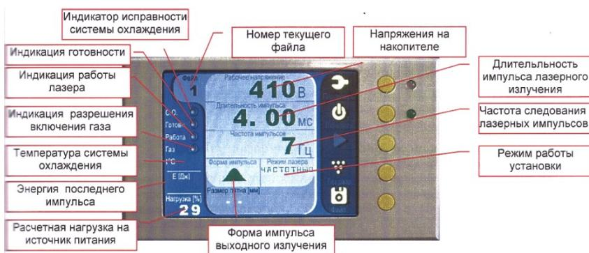
Рис. 8. Расположение индикаторов на панели управления
