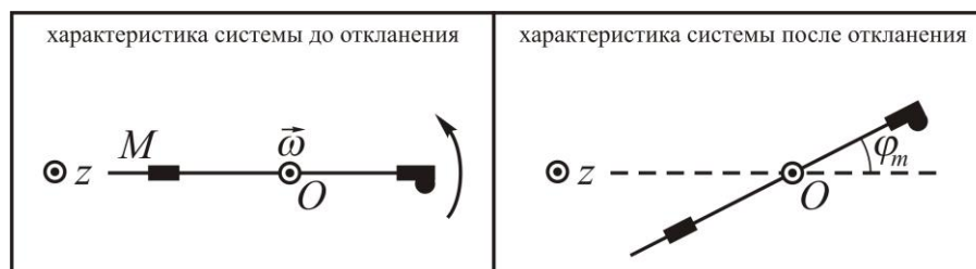
Рис. 3. Характеристика системы маятник-пуля до и после отклонения
