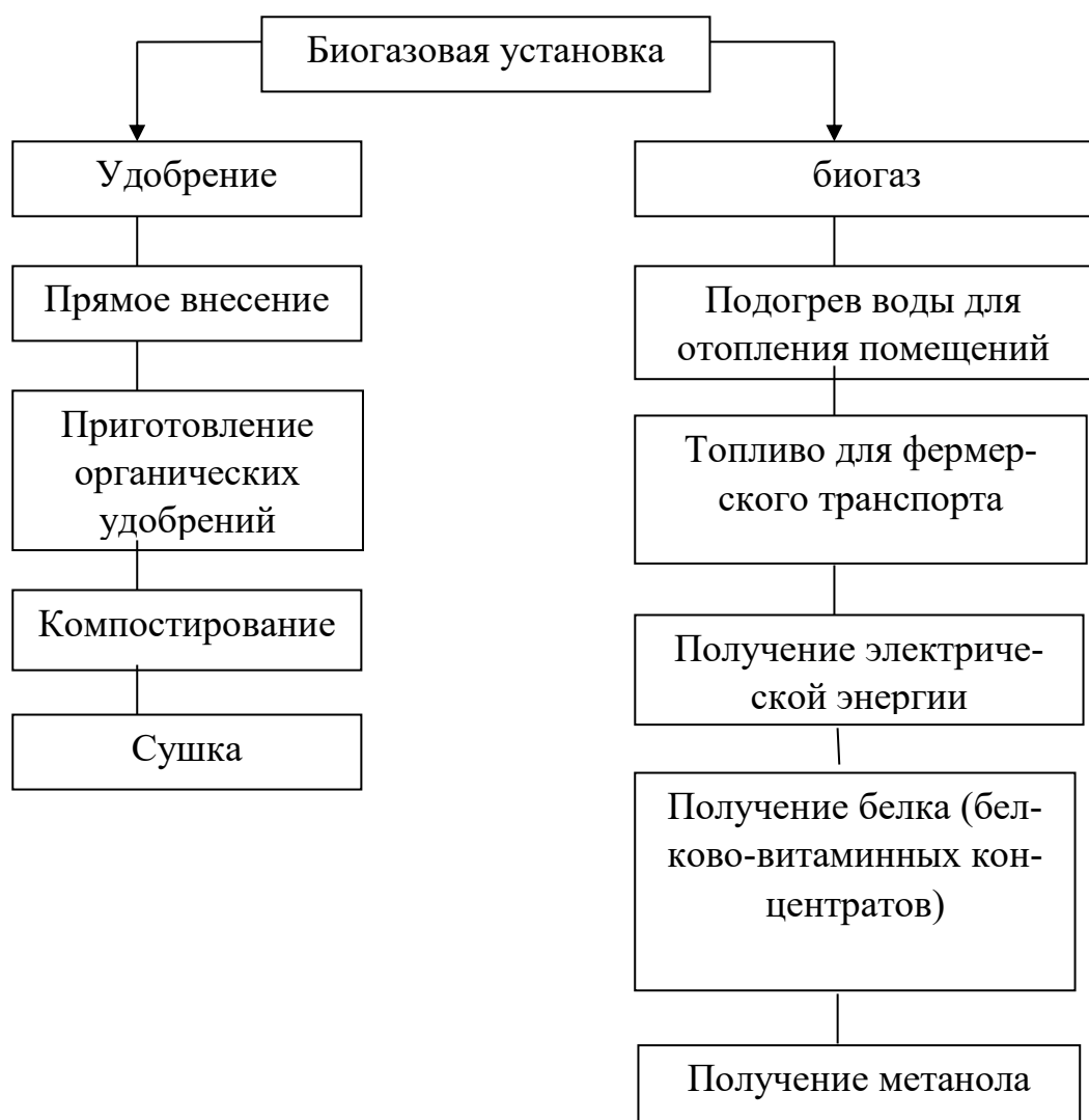
Рисунок 2 – Использование продуктов переработки отходов в биогазовой установке
