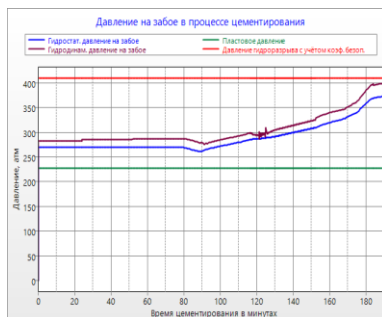
Рис. 4. Сравнение ЭЦП при разных плотностях облегченного цементного раствора (плотность 1,62 \text{ г/см}^3 на основе ПЦТ-I-G-CC-1)
