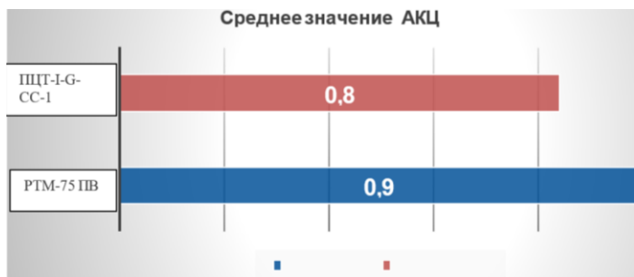
Рис. 2. Показатель коэффициента качества цементирования обсадных колонн в интервале «забой – башмак предыдущей колонны» (данные АКЦ по колоннам 168/178 мм в 2024 г.)
