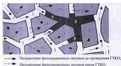
Рис. 3. Схема движения фильтрационных потоков в трещиновато-пористом карбонатном пласте до и после ГТКО: 1 – поровая нефтенасыщенная часть пласта; 2 – трещина; 3 – скоагулировавшийся полимер (гивпан)
