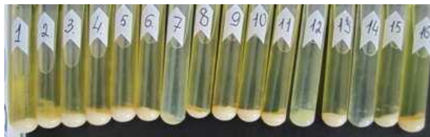
Рис. 2. Визуальная характеристика образцов – фотографии парафинистых отложений в ходе эксперимента с температурным стрессом: Скважина № 20
