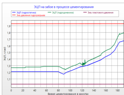
Рис. 4. Сравнение ЭЦП при разных плотностях облегченного цементного раствора (плотность 1,62 \text{ г/см}^3 на основе ПЦТ-I-G-CC-1)
