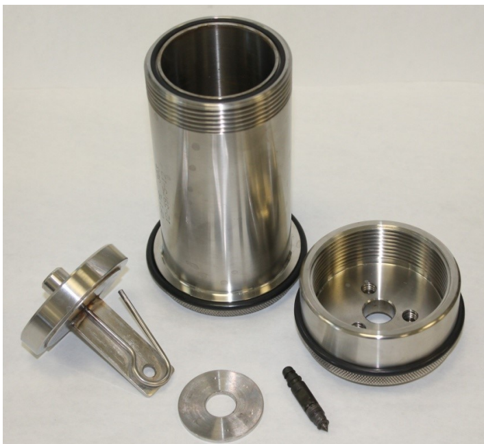
Рис. 1. Тестовая ячейка для коррозионных испытаний (ячейка старения).
