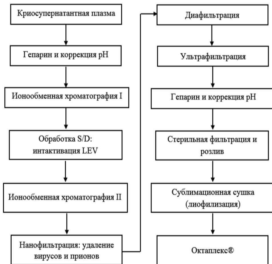
Рис. 11. Схематическое изображение современного процесса производства препарата Октаплекс®
