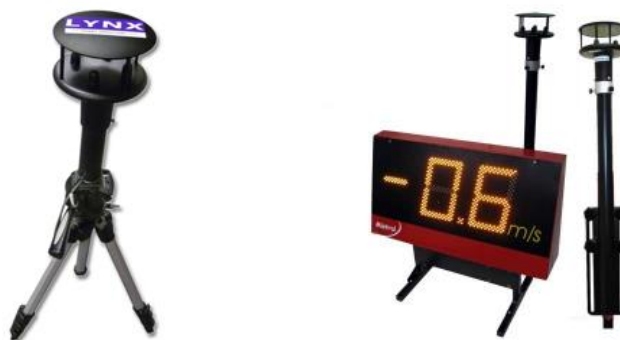
Рис. 7. Анемометр фирмы LYNX и табло-указатель ветра
