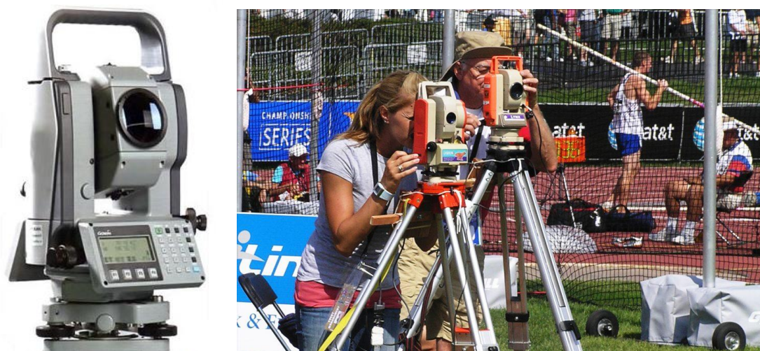
Рис. 8. Электронное устройство (лазер) для измерения расстояния LaserLynx
