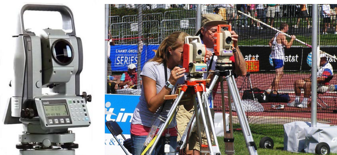
Рис. 8. Электронное устройство (лазер) для измерения расстояния LaserLynx
