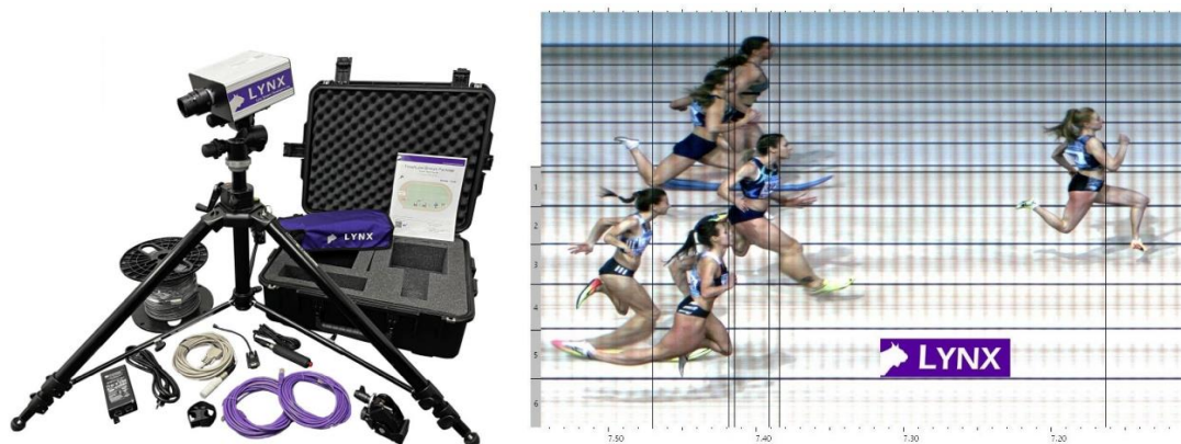
Рис. 4. Система фотофиниша и пример работы программы фотофиниша LYNX
