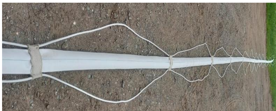
Рисунок 2 – Фотография пожарного рукава с закрепленным шнуром
