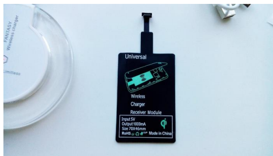
Рис. 2. Пример «наклейки – приёмник» для беспроводной зарядки 102
