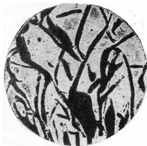
Рисунок 34. Структура чугуна с пластинчатым графитом
