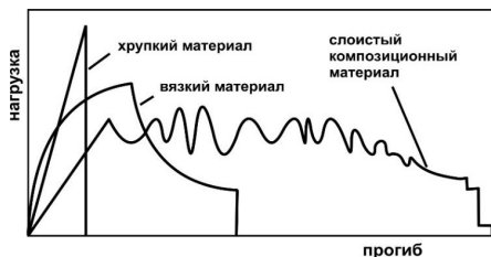
Рисунок 14. Диаграммы «нагрузка – перемещение» при испытаниях на ударную вязкость для различных материалов
