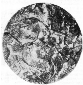
Рисунок 35. Структура серого чугуна повышенной прочности перлит+феррит+графит
