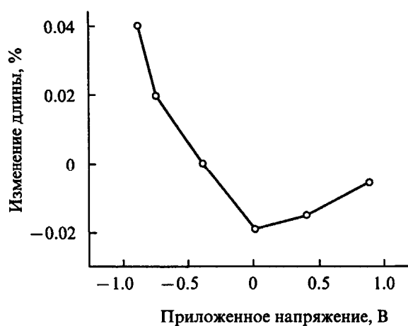
Рис. 1.9. Характеристика устройства из «нанобумаги» как актюатора [39].
