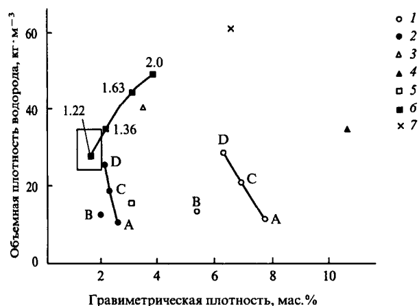
Рис. 1.11. Характеристика различных материалов как аккумуляторов водорода [64].
