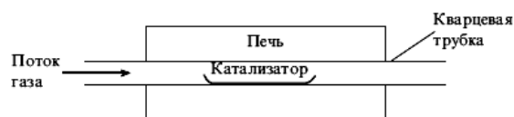
Рис. 1.7. Схема установки для получения углеродных нанотрубок методом химического осаждения.
