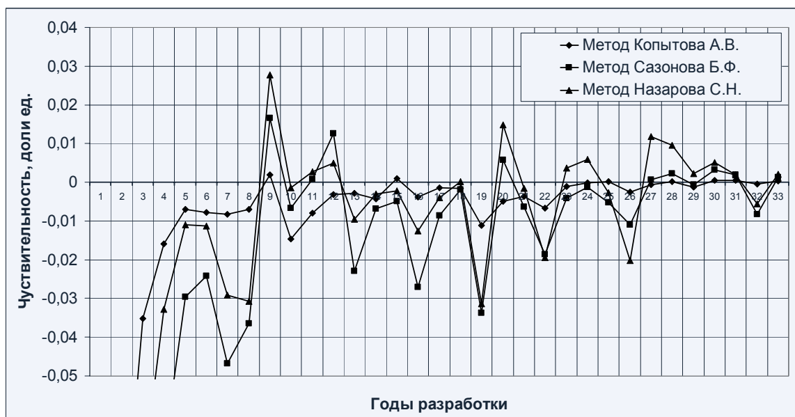
Рисунок 4.12. – Чувствительность различных методов применяемых для анализа процесса разработки Саитовского месторождения
