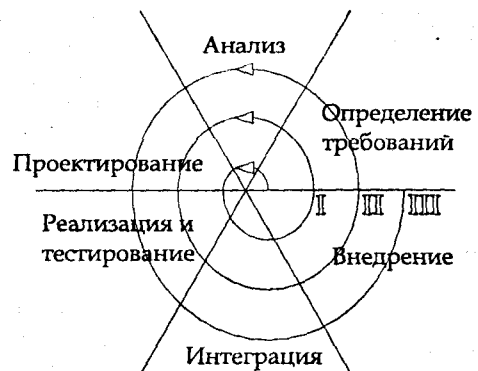
Рис. 1. Схема спиральной модели разработки МИС
