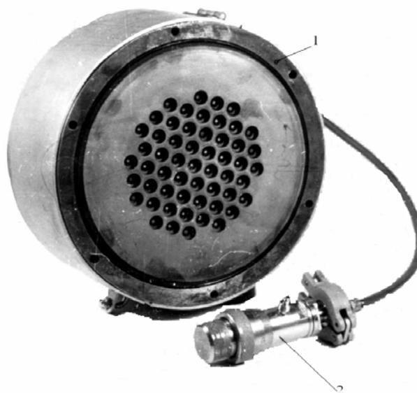
Рис.4. Ионный источник «Радикал М-100»: 1 - ионный источник, 2 – натекатель
