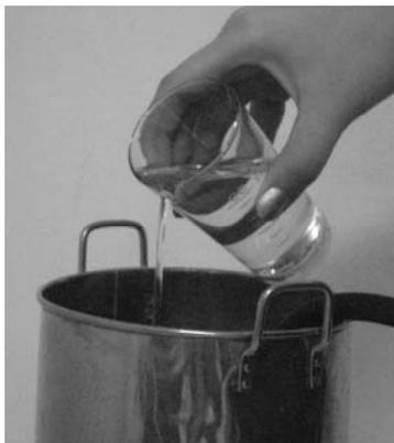
4. Подогрейте воду в сосуде с колбой, для этого добавьте в него 100 г горячей воды из лабораторного стакана. Оставьте прибор на несколько минут, пока температура воздуха в колбе не станет равной температуре воды. Повторите пункты 2 и 3.
