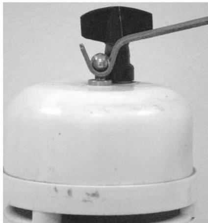
3. Ключом *B* заведите вентилятор (3-4 оборота ключа) и следите за показаниями термометров. Когда показания установятся (через 4-5 мин), их запишите в таблицу 1. Вентилятор при этом должен работать.
