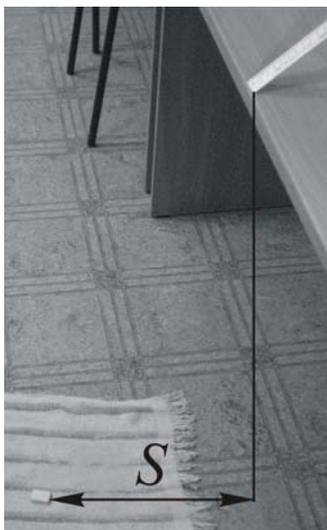
4. Положите ластик на линейку и отпустите его. По следу на тряпке определите расстояние  $S$  и запишите в таблицу 1.
