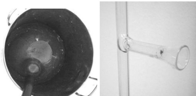
1. Заполните холодной водой сосуд на 1/4 его объема. Поместите колбу в стакан с водой. Откройте пробку. Оставьте колбу в этом положении на 4-5 мин для того, чтобы температура воздуха в ней стала равна температуре холодной воды. Закройте пробку.
