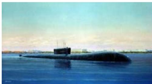
Если подводной лодке нужно погрузиться, ее воздушные полости заполняются водой, а если нужно всплыть, то воду из полости вытесняют сжатым воздухом, хранящемся в специальных баллонах.
