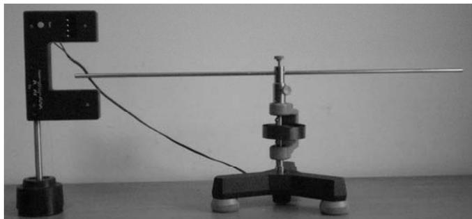
1. Измерьте период колебаний относительно оси, проходящей через центр масс стержня:  $T_{ц.м.}$ .
