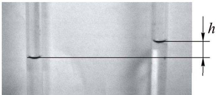
3. Для измерения давления отметьте разницу уровней  $h$  между правым и левым коленом манометра. Результат измерений запишите в Таблицу 1.
