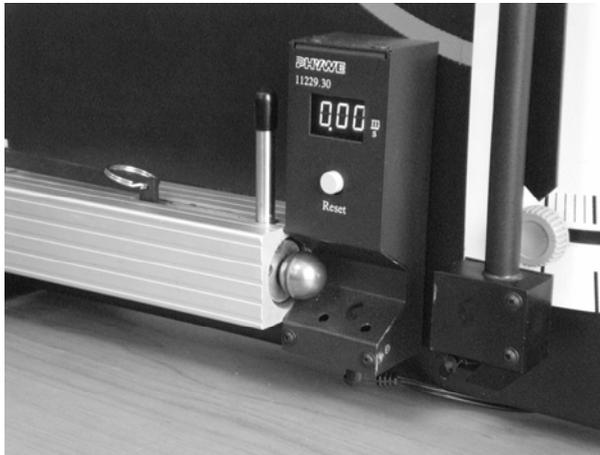
3. Прикрепите шарик к магниту стреляющего устройства, растяните пружину. Затем оттяните курок назад до упора. Убедитесь, что стрелка показывает на отметку «ноль». Спустите курок. Определите угол отклонения маятника  $\alpha$ . Снимите показания с приставки определения скорости –  $v_l$ . Опыт повторить 5 раз. Результаты измерений занесите в таблицы 1.
