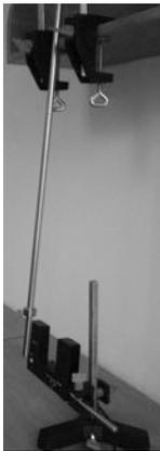
3. Отклоните маятник от положения равновесия на малый угол. Нажатием на кнопку «Set» счётчика времени обнулите дисплей светового барьера. Отпустите маятник и снимите показания прибора (период колебаний  $T_A$ ). Результаты измерений запишите в таблицу 1.
