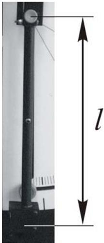
2. Измерьте расстояние от оси вращения до центра ловушки баллистического маятника  $l$ . Результат измерений запишите с учетом погрешности прибора:
