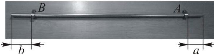
1. Поместите втулки  $A$  и  $B$  на расстояниях  $a = 6$  см,  $b = 8$  см от соответствующих концов стержня. В дальнейшем положение втулки  $A$  на протяжении всего эксперимента не менять.
