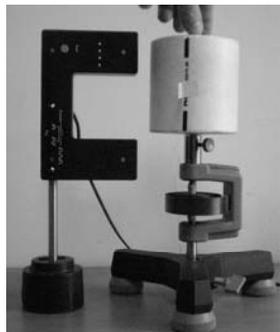
3. Поверните цилиндр на угол  $\varphi \approx 90^\circ$ . Нажатием на кнопку «Set» обнулите дисплей светового барьера. Отпустите цилиндр и снимите показания прибора (период колебаний  $T_{ц}$ ). Результаты измерений занесите в таблицу 1.
