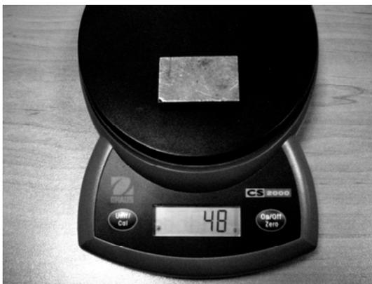
1. С помощью весов определите массу  $m$  бруска. Результат измерений запишите с учетом погрешности прибора:
