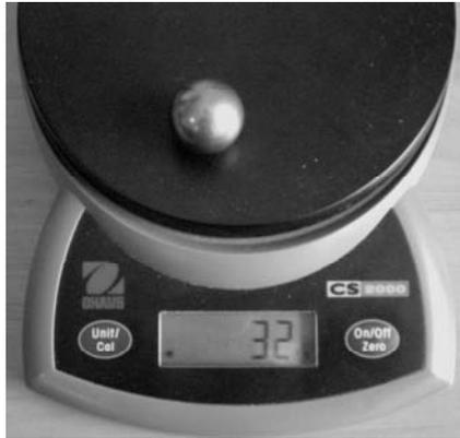
1. Измерьте массу пули  $m$ . Результат измерений запишите с учетом погрешности прибора:
