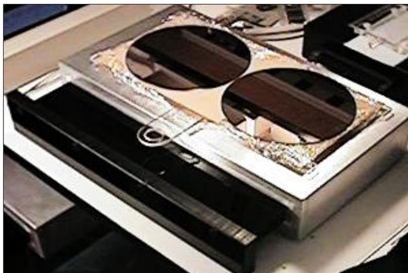
Рисунок 1 - Вид пропорционального газового счётчика модели 1950 производства “Alpha Sciences Inc.”, США с лотком.
