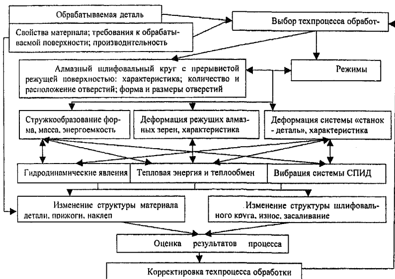
Рис. 1. Схема построения системы «процесс шлифования».
