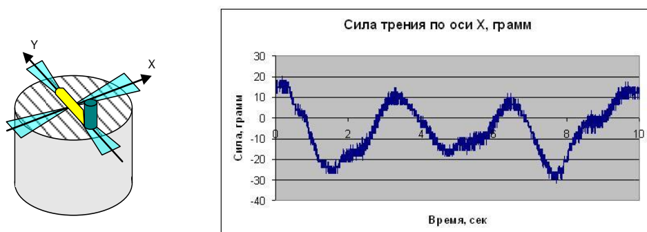
Рис. 8. График изменения компоненты силы трения (ось X), действующей ортогонально направлению главного движения (ось Y).
