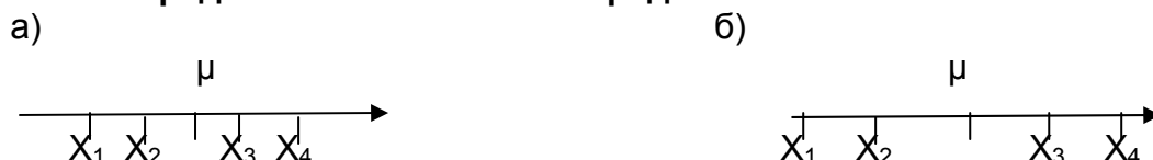
Рис. 3. Две серии однотипных измерений с разным разбросом, но одинаковым средним отклонением от среднего.
