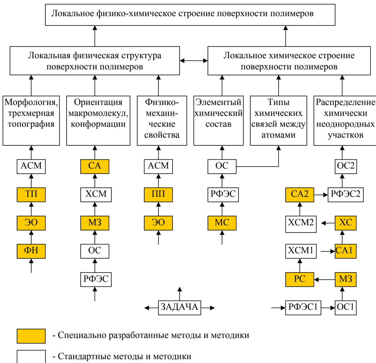
Рис.6. Структурная схема алгоритма применения стандартных и специально разработанных методов и методик для диагностики локального физико-химического строения поверхности и межфазных слоев полимерных композиционных материалов
