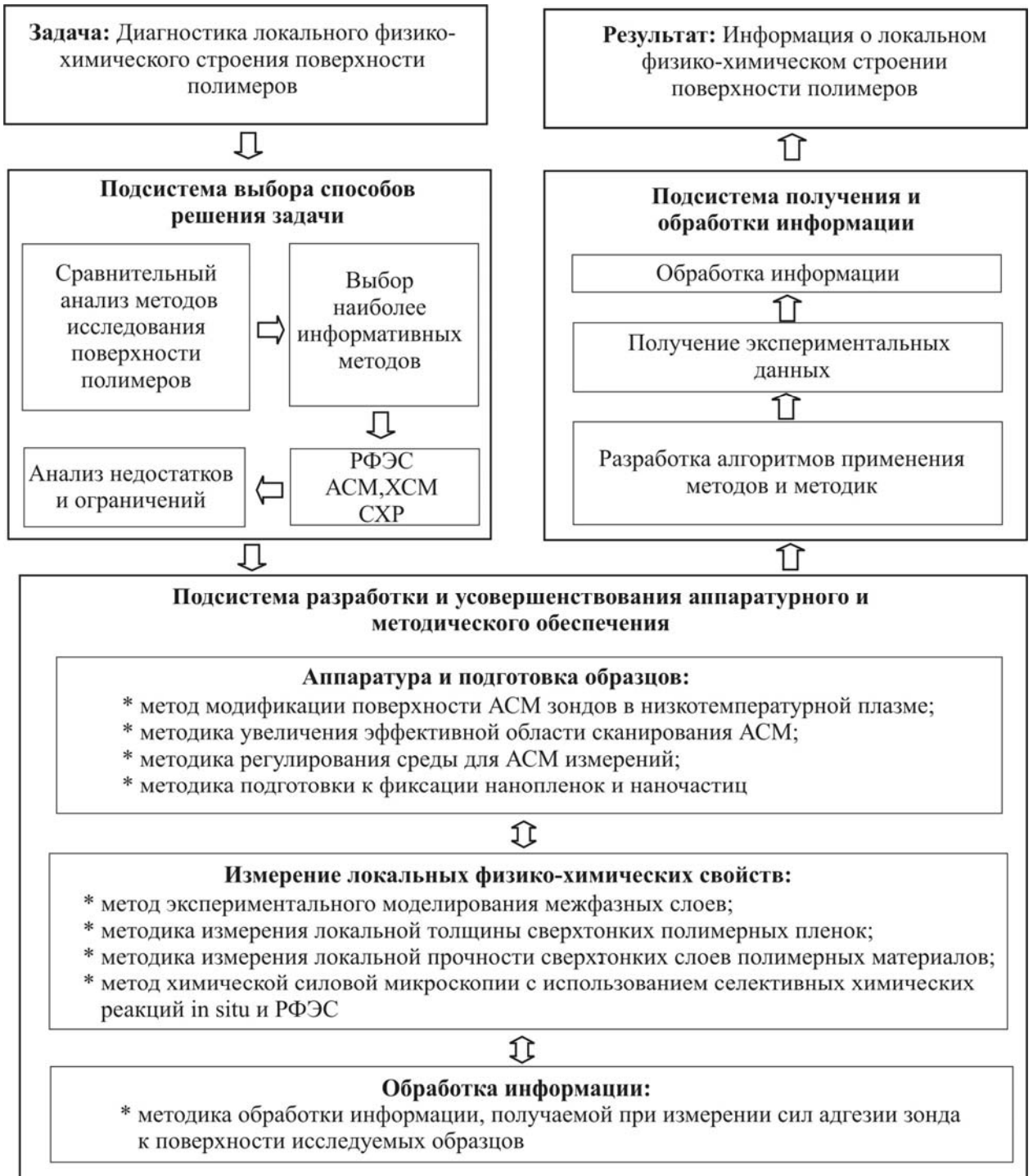
Рис.8. Структурная схема системы диагностики на наноразмерном уровне локального физико-химического строения поверхности и межфазных слоев полимерных композиционных материалов
