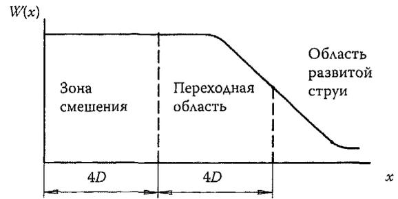
Рис. 3. Распределение акустической мощности, излучаемой струей, истекающей из сопла диаметром  $D$
