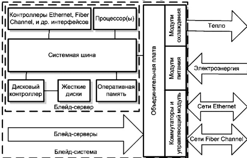
Рис. 7. Декомпозиционная функциональная структура блейд-сервера
