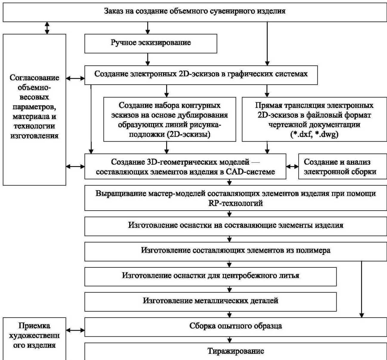
Рис. 2. Блок-схема методики дизайна художественных изделий с применением технологий быстрого прототипирования
