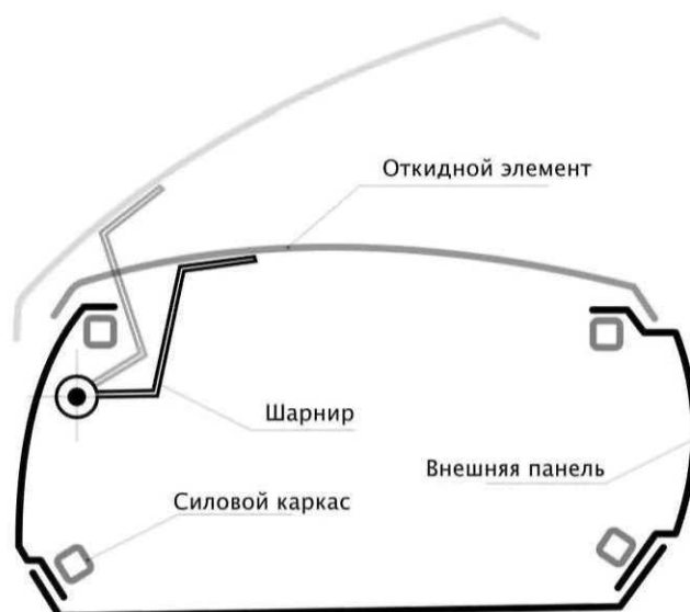
Рис. 1. Принципиальная схема каркасно-панельной конструкции
