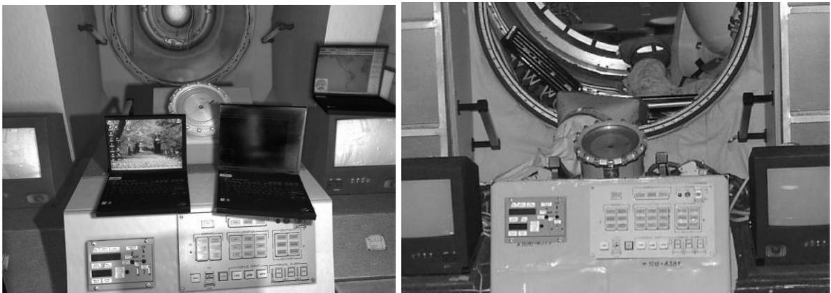
*Рис. 9. Виртуальная модель блока управления бортовой системой (слева) и его прототип (справа) в макете модуля «Звезда» в ЦПК им. Ю. А. Гагарина.*
