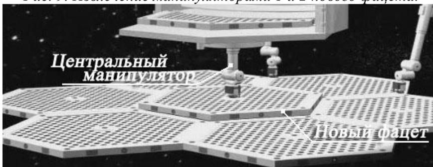
Рис.10. Установка центральным манипулятором нового фацета в общую конструкцию ФАР.
