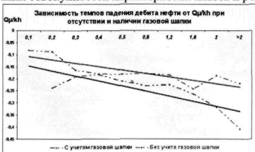
Рис. 4 Зависимость темпа падения дебита нефти от наличия/отсутствия газовой шапки
