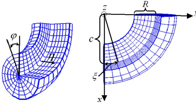
Рис. 1: Система координат на криволинейном участке канала
