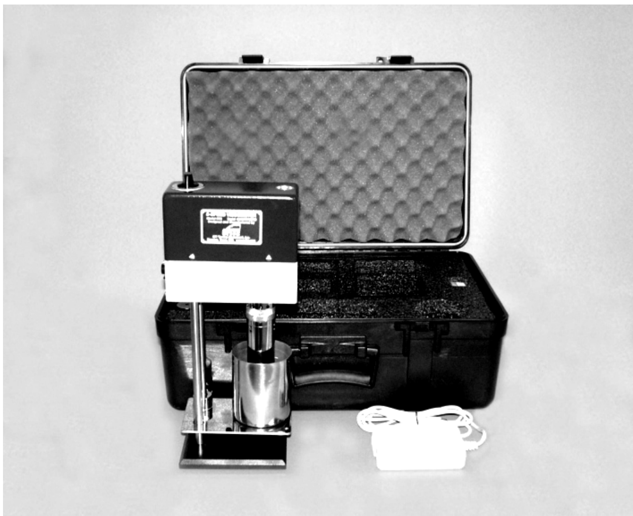
Рис.1. Внешний вид ротационного вискозиметра OFITE
