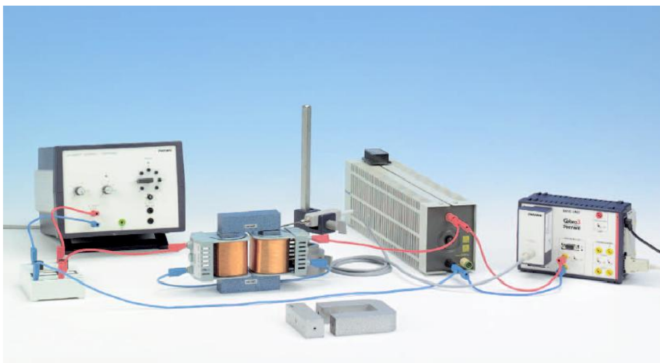
Рис. 2. Экспериментальная установка для изучения гистерезиса ферромагнитных материалов
