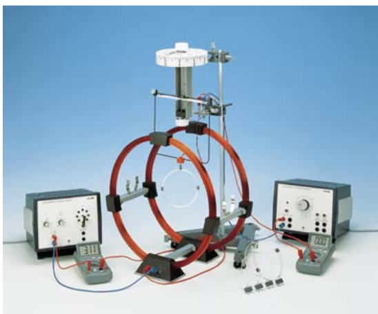
Рис. 1. Экспериментальная установка для определения значения вращающего момента рамки с током, помещенной во внешнее магнитное поле.
