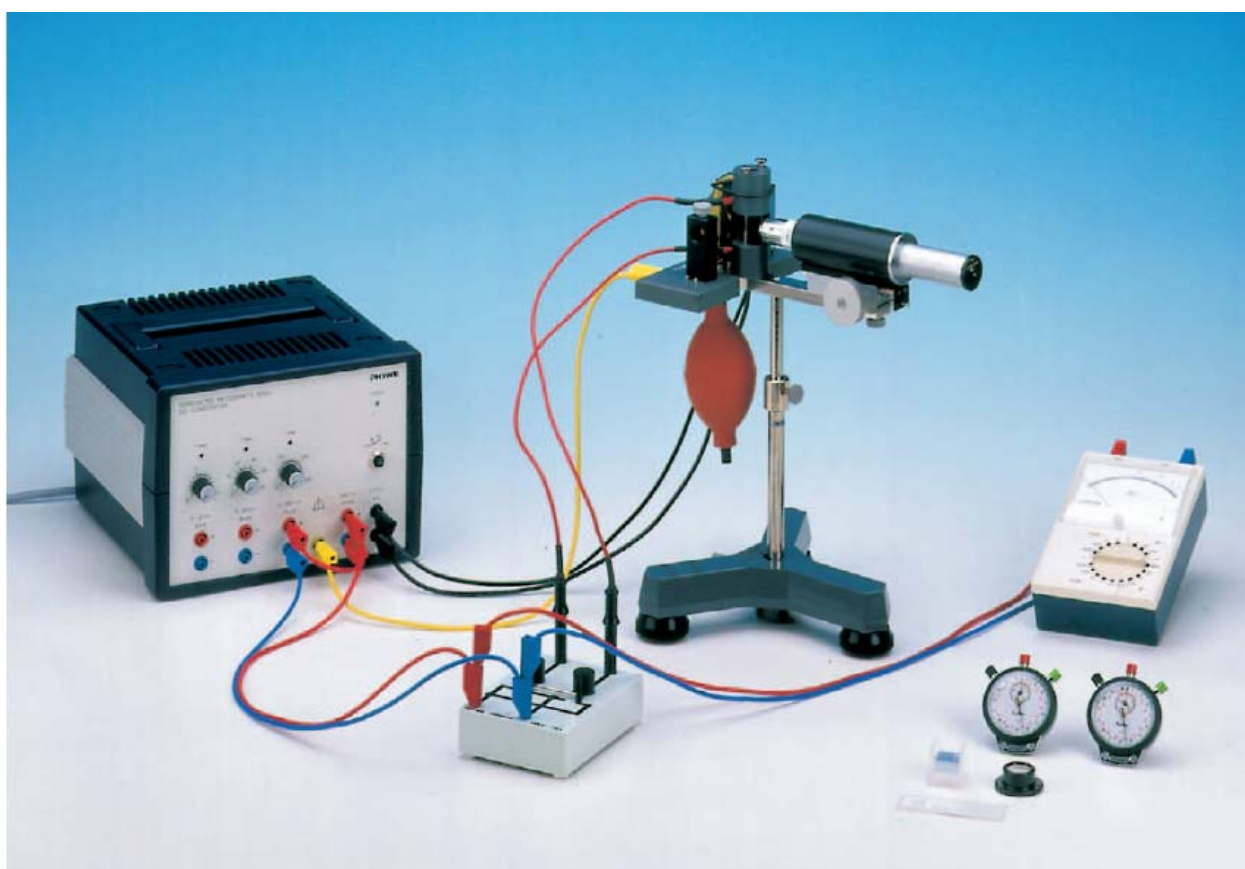
Рис. 1. Экспериментальная установка для определения элементарного заряда с помощью устройства Милликена
