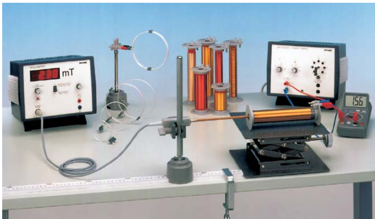
Рис. 2. Экспериментальная установка для измерения магнитного поля.
